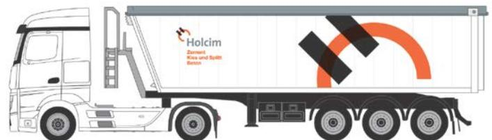
**Abb.3: Mercedes Benz Actros mit Kempf Mulde und Plane**
