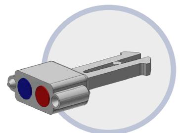
Da das Kupplungsniveau im Zugverband technisch bedingt abgesenkt ist, sind die Wagen mit einer eigens entwickelten Niederflerkupplung ausgestattet. Diese spezielle Kupplung ist eine 2-polige, elektrisch leitende Magnetkupplung, welche die Steuersignale des Funktionsdecoders überträgt und nebenbei auch noch das Zusammenkuppeln erleichtert.
